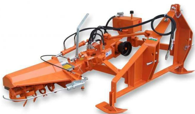
Figura 5: Esempio di fresatrice interceppo per le lavorazioni sulla fila
