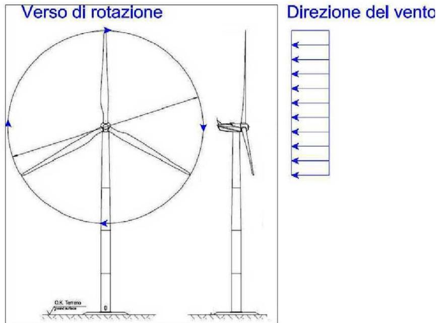
Figura 1: Relazione tra le direzioni del vento e il verso di rotazione del rotore
