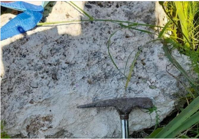
Figura 3.10 - Calcareniti polverulente in prossimità del sito WTG02
