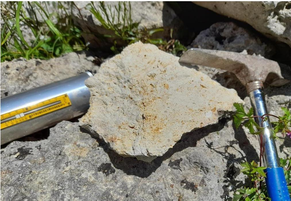
Figura 3.5 – Calcareniti debolmente marnose alla sommità del rilievo di impianto dell'aerogeneratore WTG02
