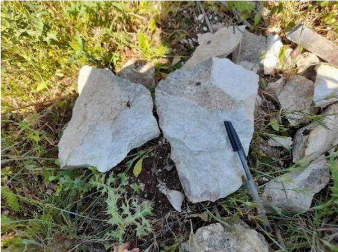
*Figura 3.8 - Calcareniti a noduli algali ben cementati in prossimità del sito WTG03*
