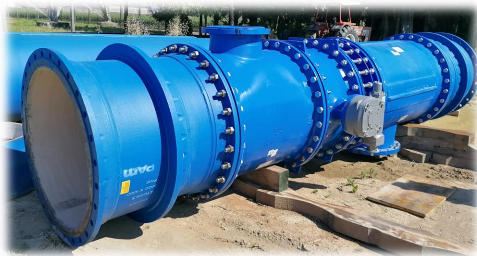
Esempio di tubazioni in ghisa sferoidale con raccorderia
