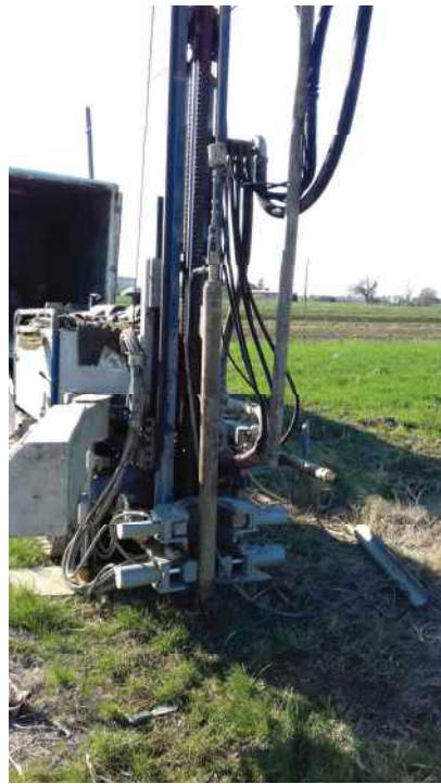
Strumentazione utilizzata Perforatrice EK200S per campionamento terre.
