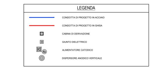
SCHEMA PLANIMETRICO IMPIANTO DI PROTEZIONE CATODICA n.A1
