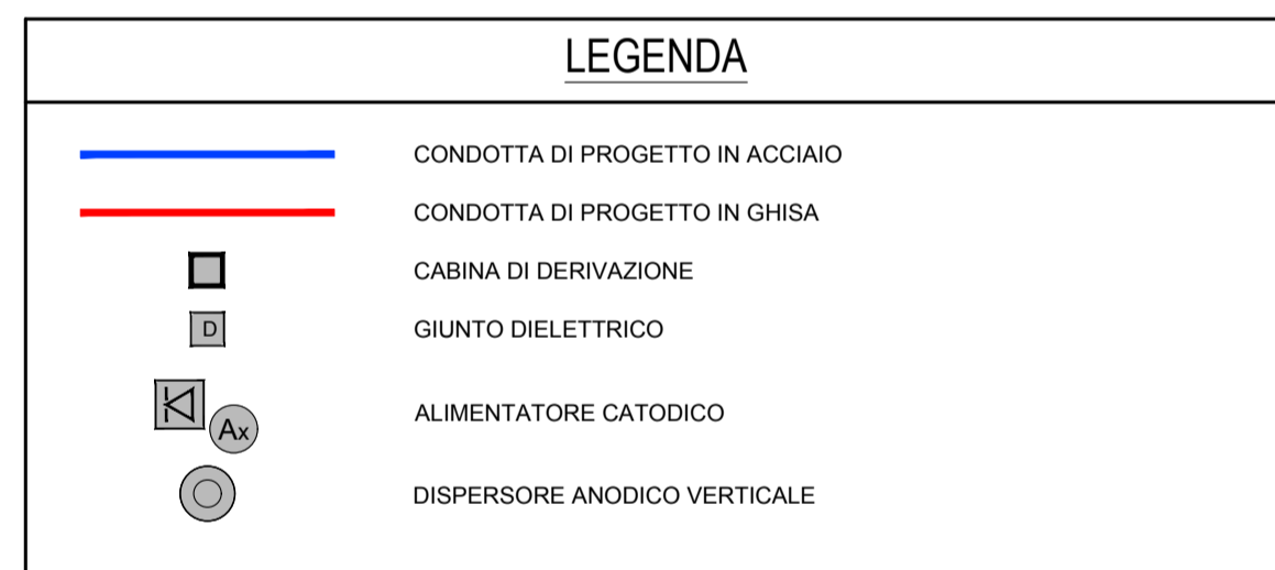
SCHEMA FUNZIONALE IMPIANTO DI PROTEZIONE CATODICA A CORRENTE IMPRESSA CON DISPENSORE ANODICO VERTICALE
