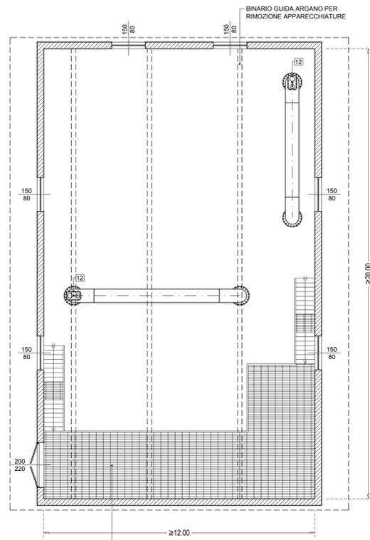
BALLATOIO IN CARPENTERIA METALLICA PER QUADRI ELETTRICI, TELECONTROLLO E RAGGIUNGIMENTO APPARECCHIATURE
