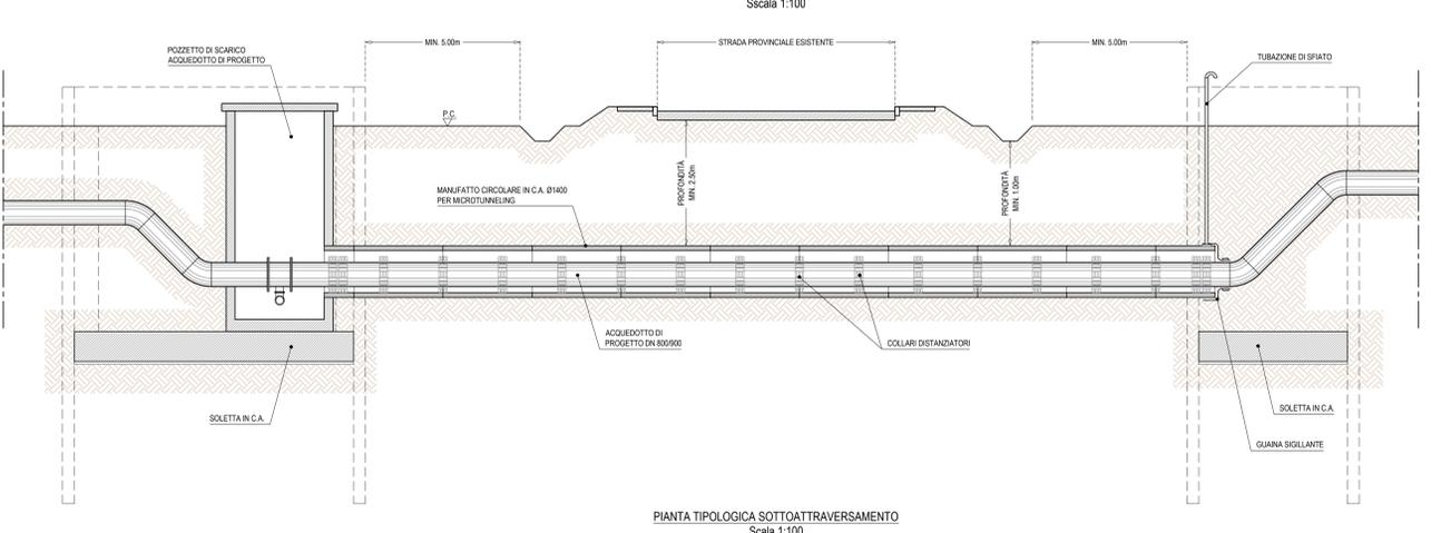
PIANTA TIPOLOGICA SOTTOATTRAVERSAMENTO
