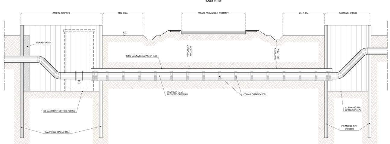
SEZIONE TIPOLOGICA SOTTOATTRAVERSAMENTO
