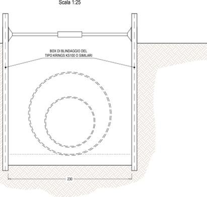
SEZIONE TIPOLOGICA SOTTOATTRAVERSAMENTO A CIELO APERTO
