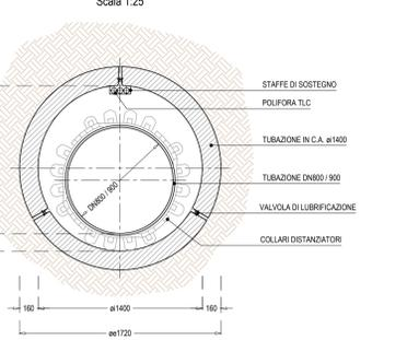
SEZIONE TIPOLOGICA IN FASE DI SCAVO A CIELO APERTO
