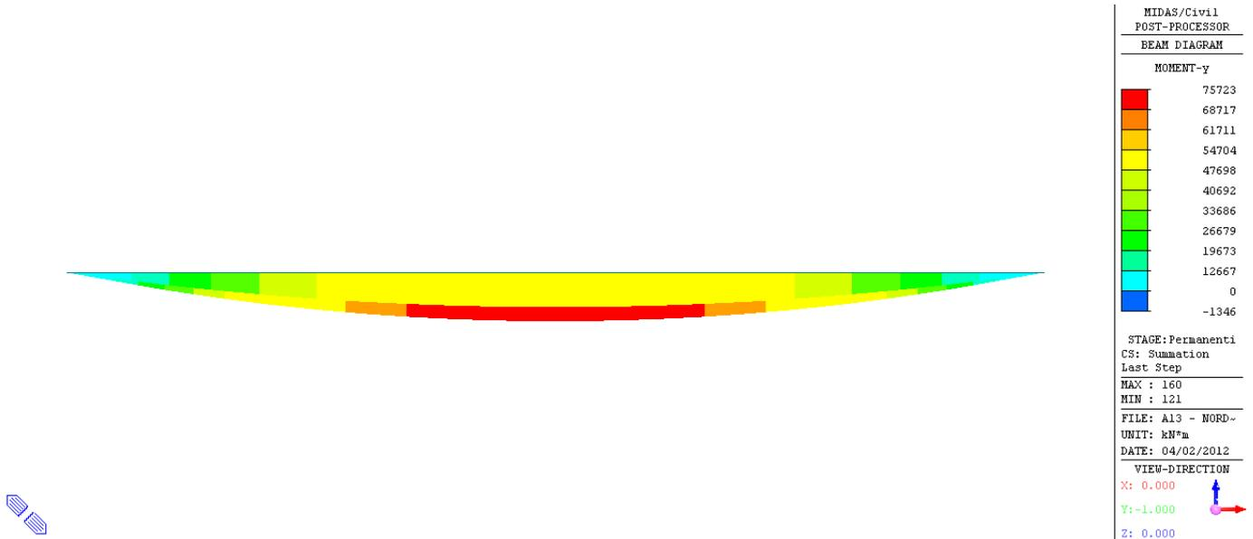
**FIG. 8.2-11 AZIONE DELLA TEMPERATURA (TEMP. ESTATE) – MOMENTO FLETTENTE MY (kN)**
