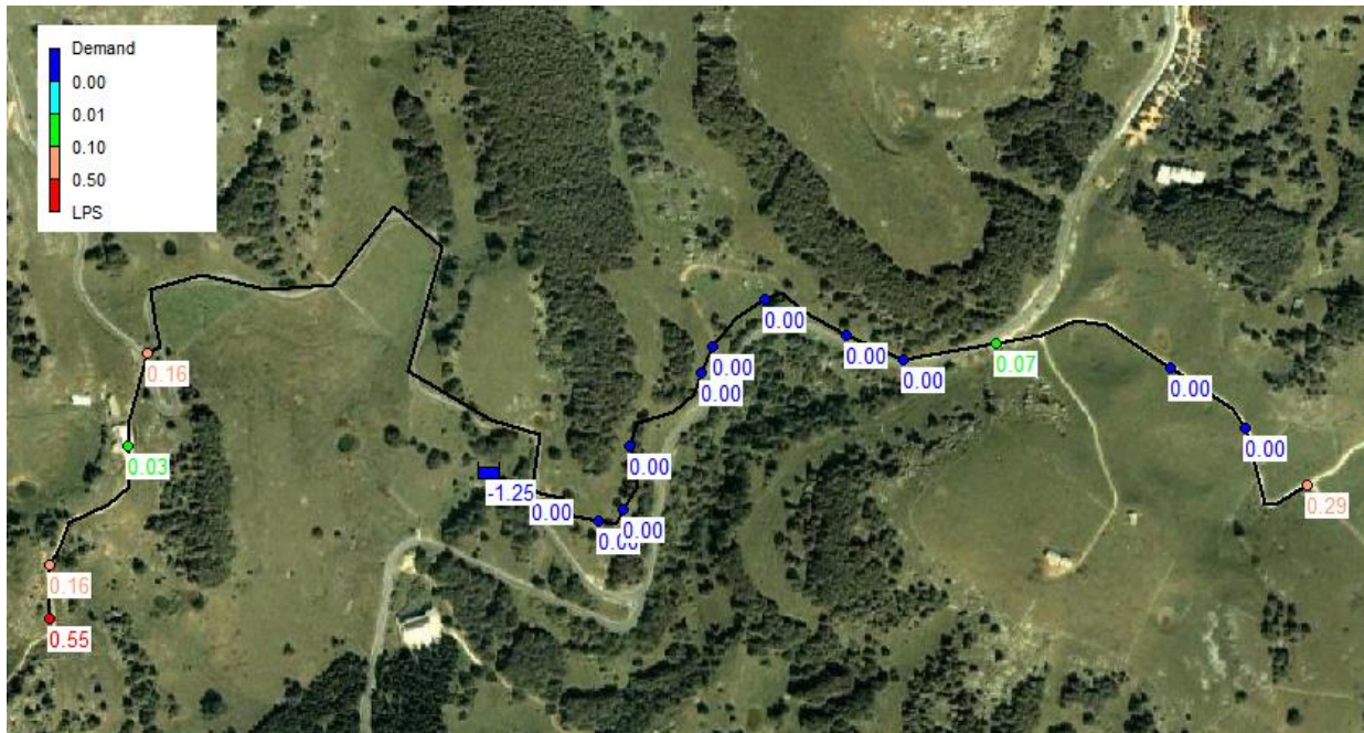
Figura 27: Mappa dell'andamento della domanda idrica ai nodi nel tratto IL – comune di Bosco Chiesanuova
