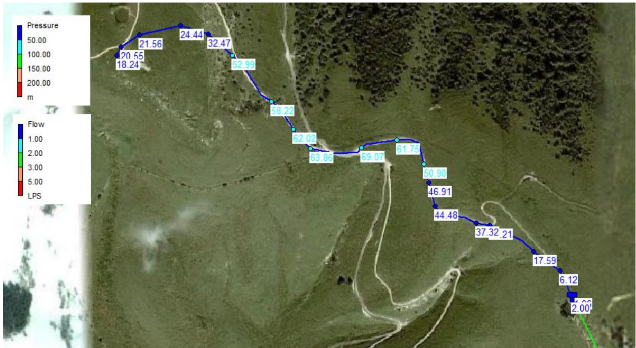
Figura 20: Mappa dell'andamento delle pressioni nel tratto AB dal serbatoio Monte Cornetto – comune di Sant'Anna.
