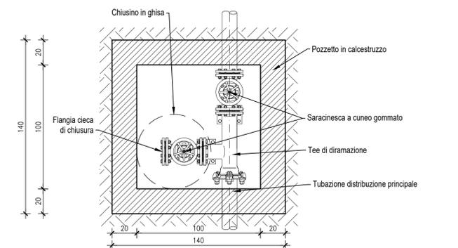
**POZZETTO DI SCARICO**
