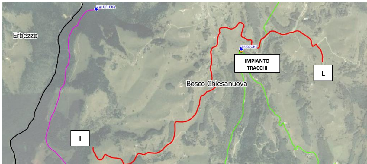
Figura 9: Planimetria generale del tracciato IL. In rosso il tracciato di progetto, in verde la rete esistente.
