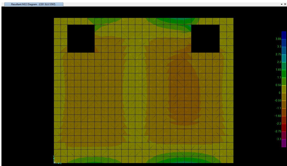
Figura 63: Soletta copertura M 22
