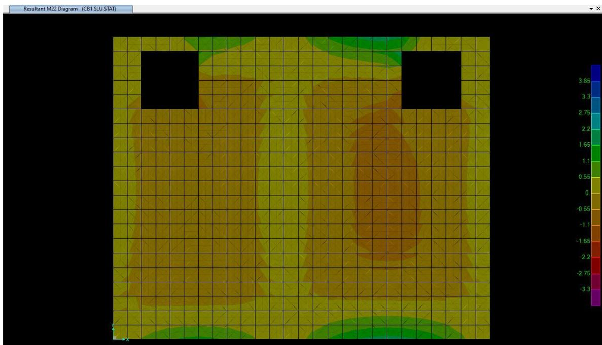
Figura 63: Soletta copertura M<sub>22</sub>
