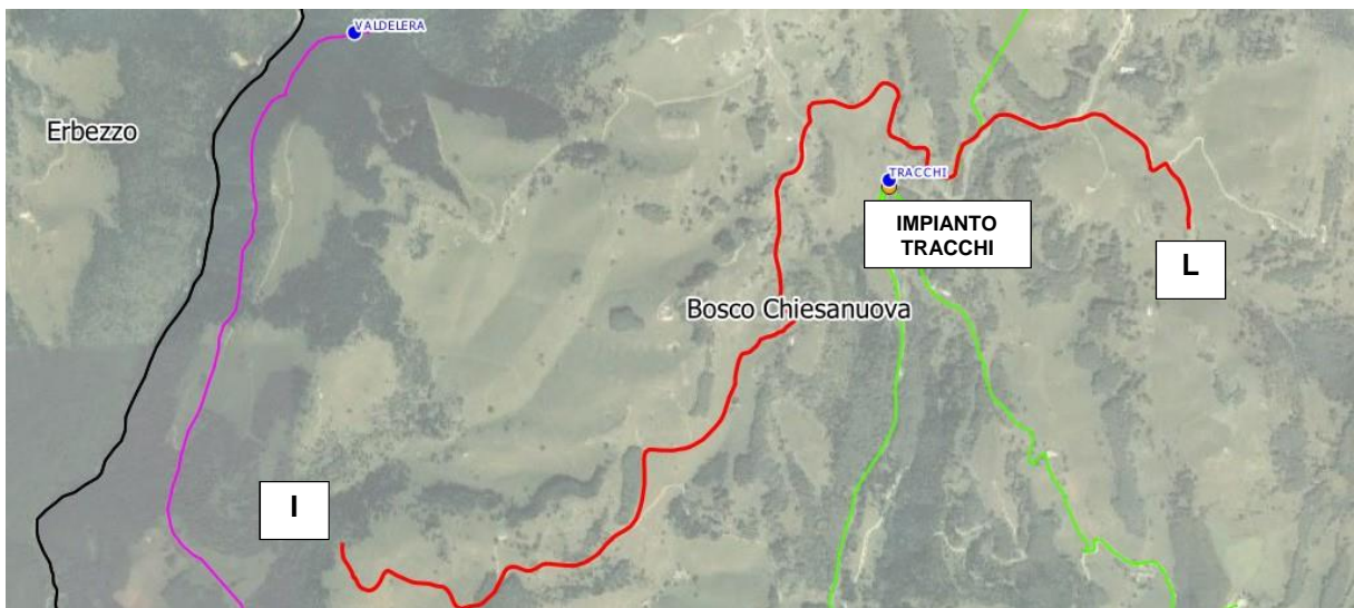
Figura 7: Planimetria generale del tracciato IL. In rosso il tracciato di progetto, in verde la rete esistente.
