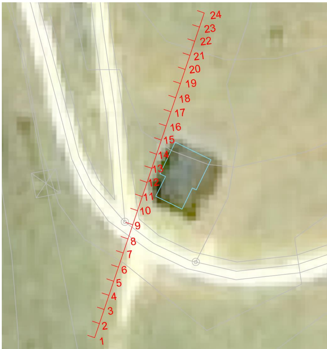
In rosso ubicazione planimetrica dello stendimento. I numeri progressivi indicano gli elettrodi.
