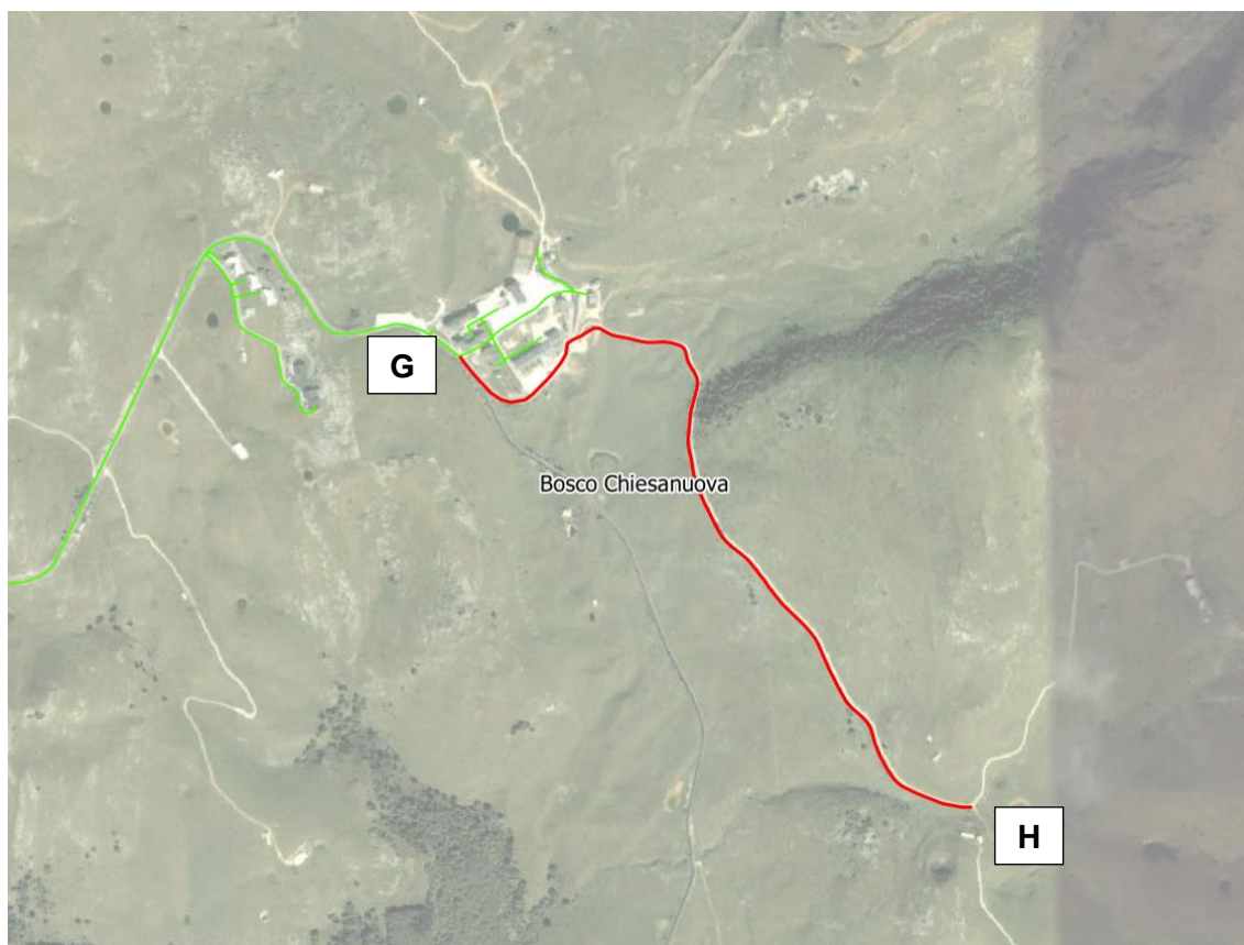
Planimetria generale del tracciato G - H. In rosso il tracciato di progetto, in verde la rete esistente.
