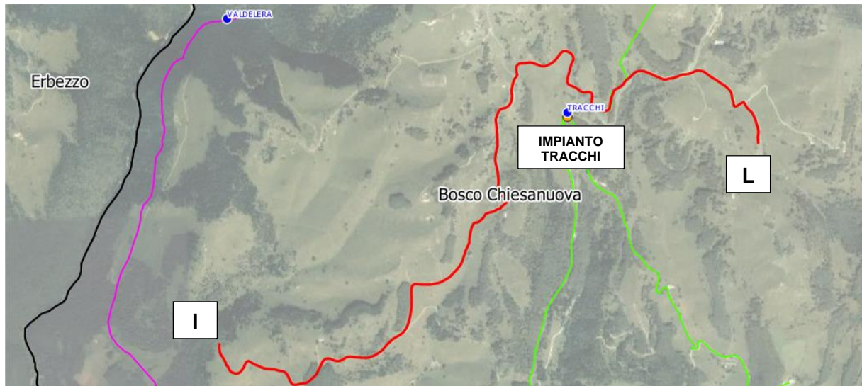
Planimetria generale del tracciato I - L. In rosso il tracciato di progetto, in verde la rete esistente.
