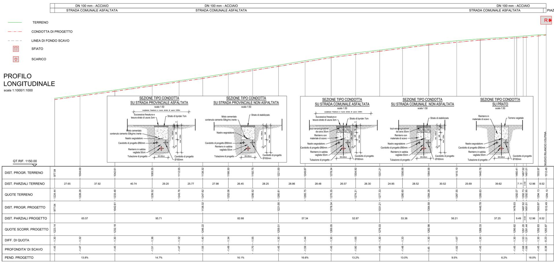
La posa della tubazioni, in corrispondenza di strade asfaltate in ambito comunale e provinciale, prevede il taglio di pavimentazione in conglomerato bituminoso (F.02.08.A e F.02.08.B) per un totale di 10 cm di altezza.
