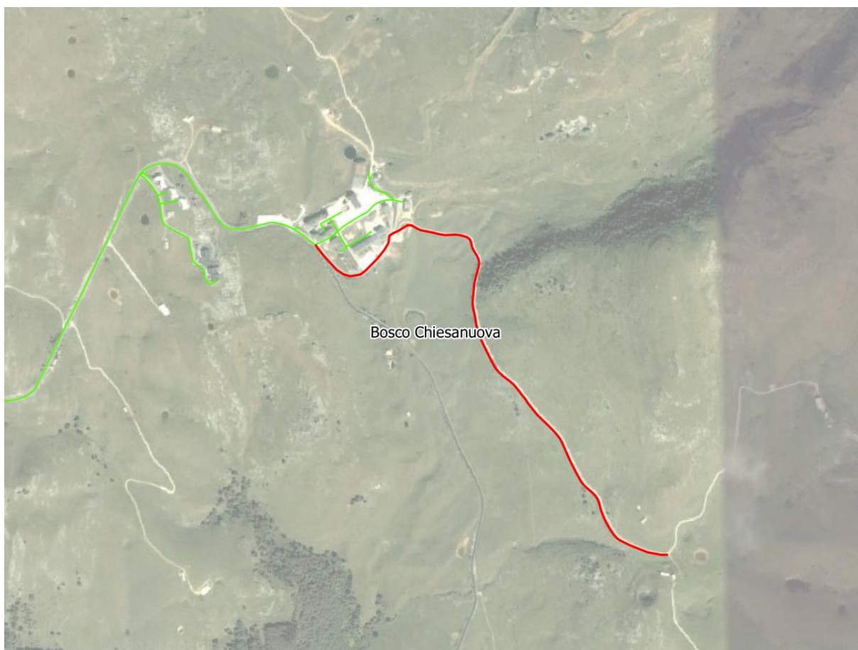
Figura 6: Planimetria generale del tracciato GH. In rosso il tracciato di progetto, in verde la rete esistente.
