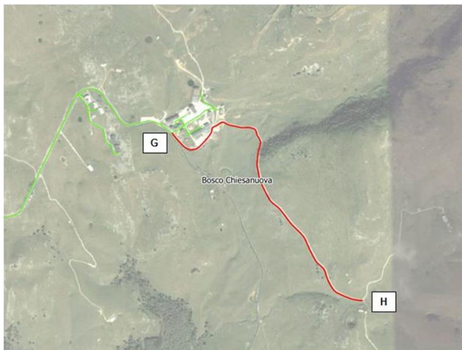
Figura 5: planimetria generale del tracciato GH. In rosso i tracciati di progetto, in verde la rete esistente.
