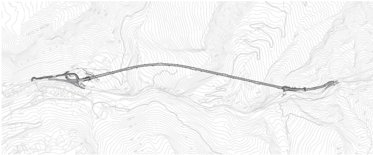
Figura 16: AN 256 – SS4 Salaria – Tratto Trisungo – Acquasanta Terme 1° Lotto 2° Stralcio dal km 151+000 al km 153+780 - Planimetria e profilo longitudinale
