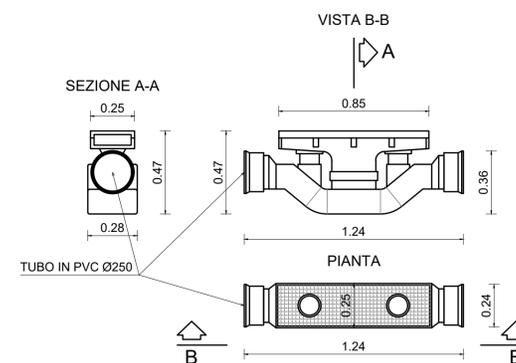
**POZZETTO DI ISPEZIONE**
