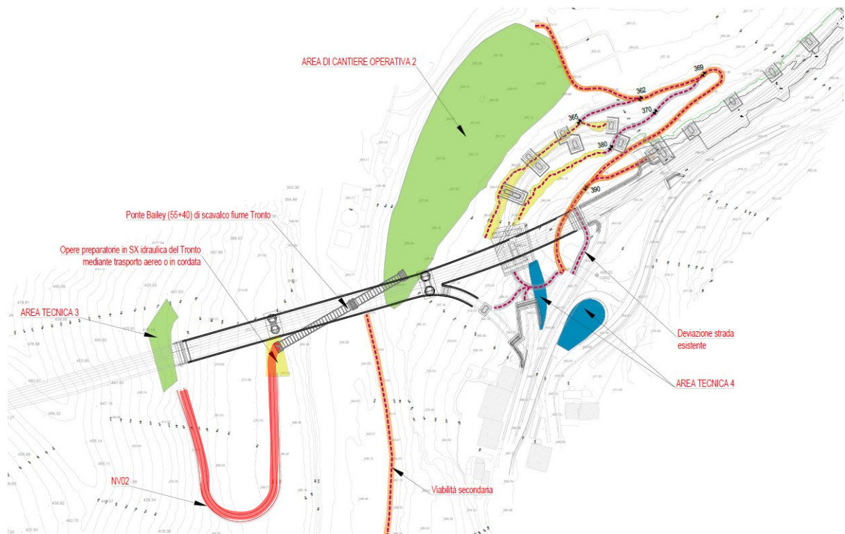
Figura 25 – Dettaglio accessibilità in fase di cantiere – area svincolo
