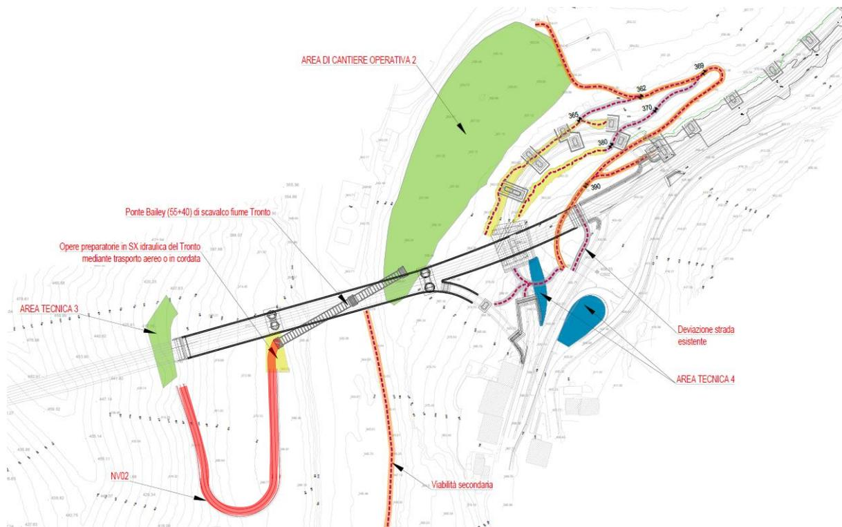
Figura 3.40 – Dettaglio accessibilità in fase di cantiere – area svincolo
