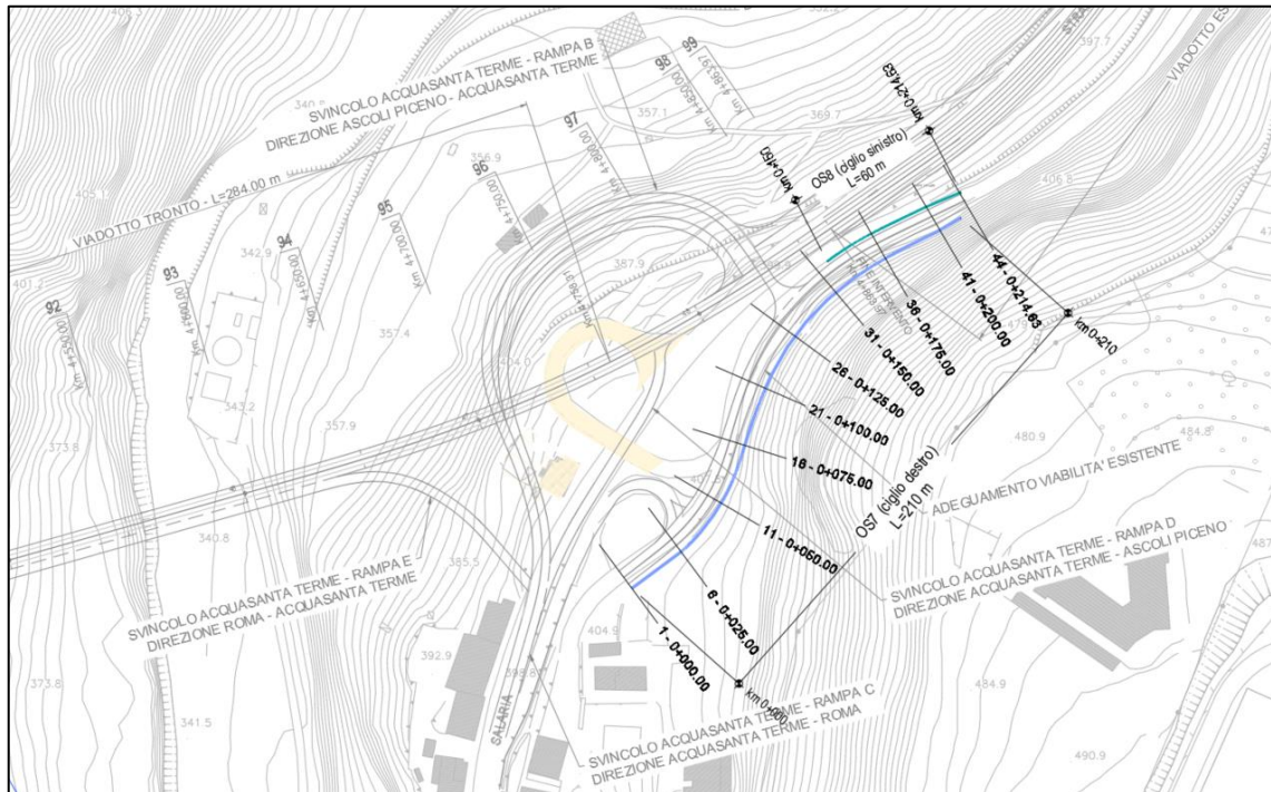
Figura 3 – Svincolo Acquasanta Terme – ubicazione planimetrica opere secondarie.
