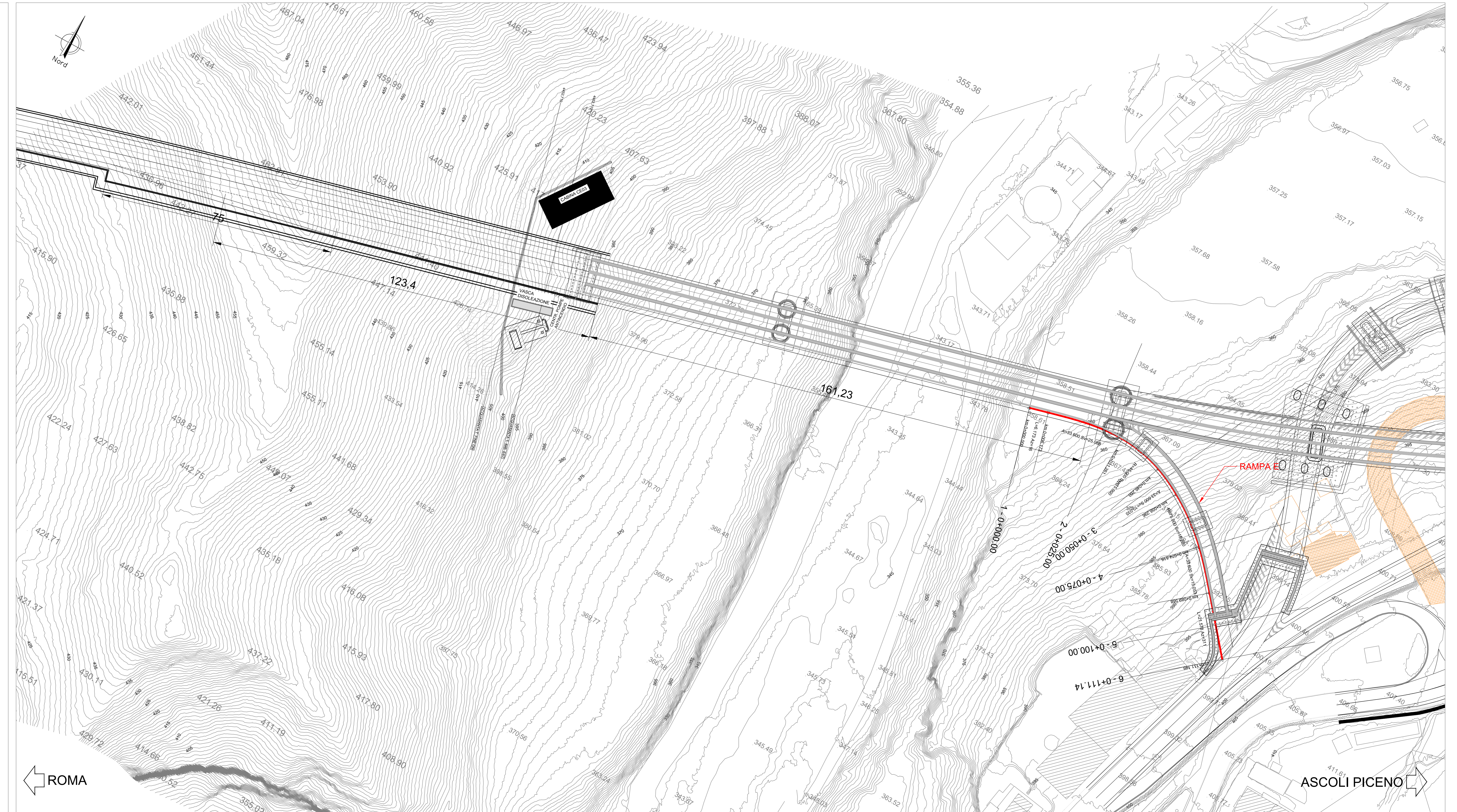
PLANIMETRIA DI PROGETTO E TRACCIAMENTO RAMPA E - SCALA 1:500
