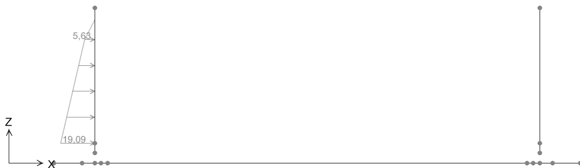
FIGURA 7.6 – CONDIZIONE DI CARICO ST1
