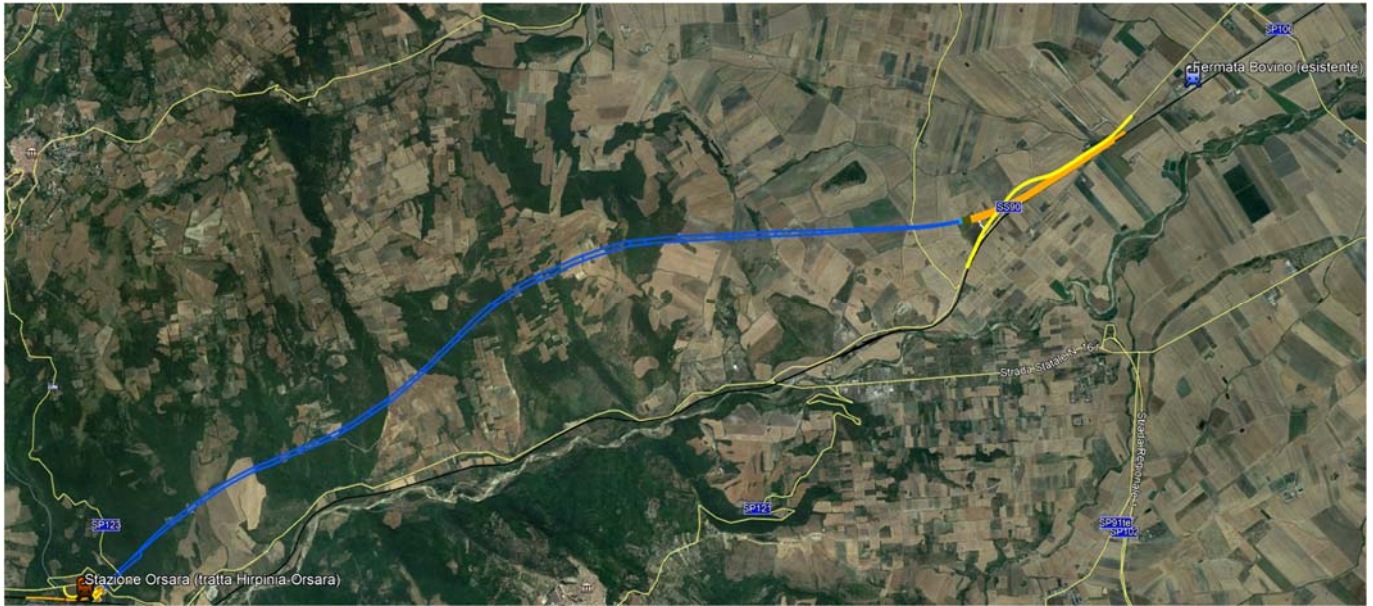
Figura 2 - Corografia della linea. In blu la tratta in galleria, in arancio la tratta in rilevato ed in giallo le nuove viabilità.
