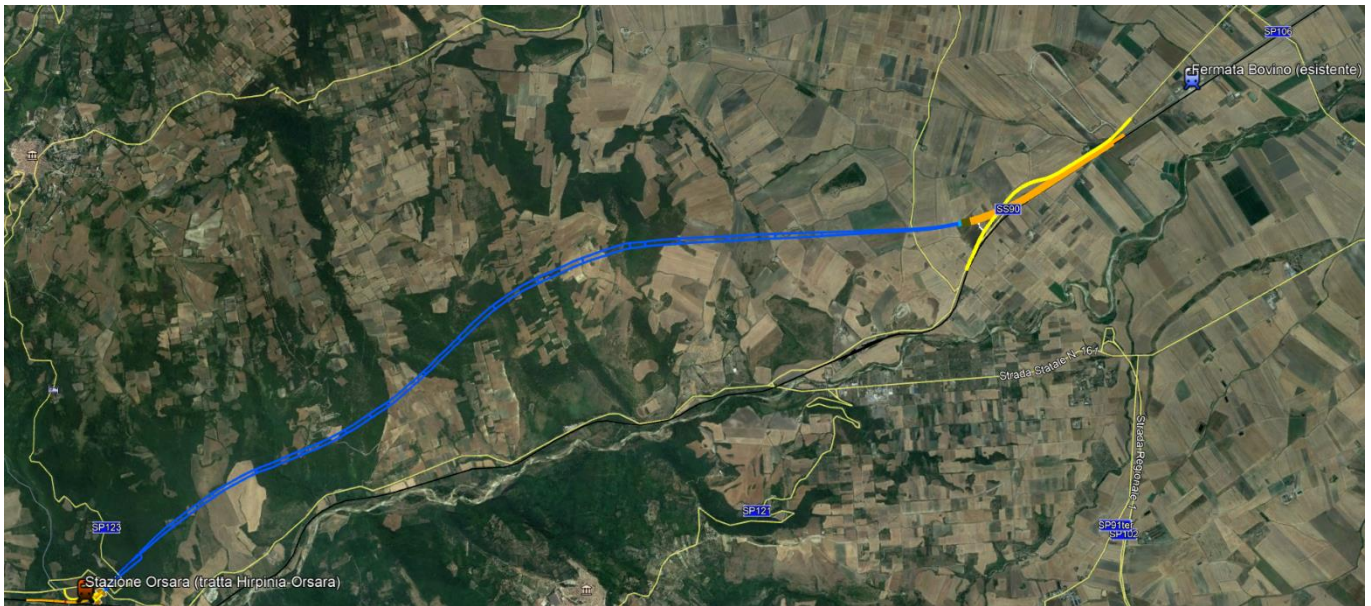
Figura 2-2. Corografia della linea. In blu la tratta in galleria, in arancio la tratta in rilevato ed in giallo le nuove viabilità.
