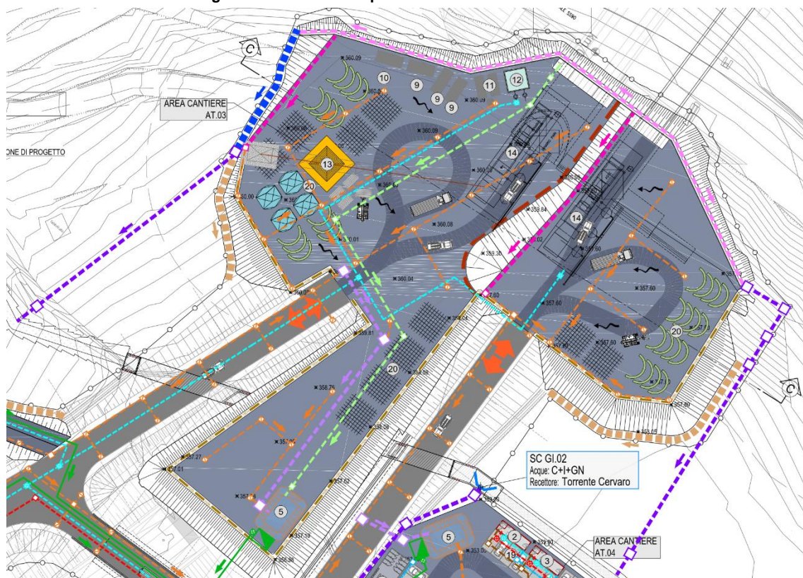
Figura 4-2- Gestione acque di versante Area AT.03
