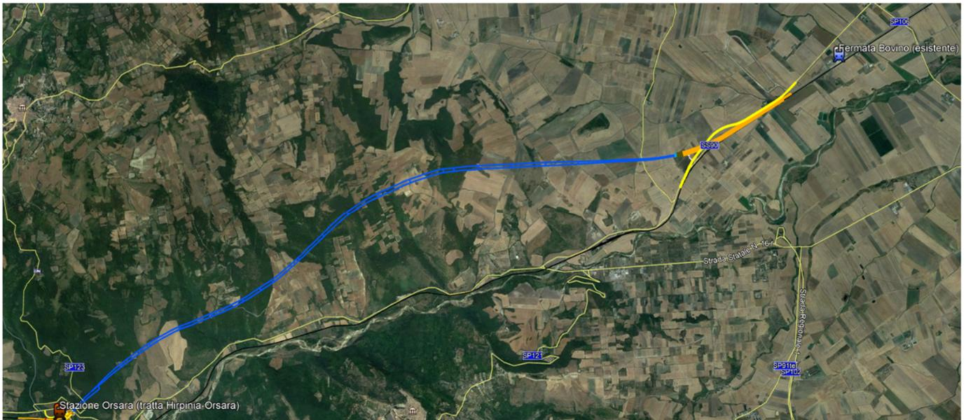
Figura 3-2. Corografia della linea. In blu la tratta in galleria, in arancio la tratta in rilevato ed in giallo le nuove viabilità.
