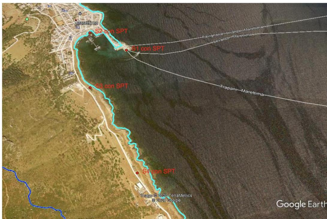
Figura 46 - Ubicazione sondaggi geognostici in foro con SPT
