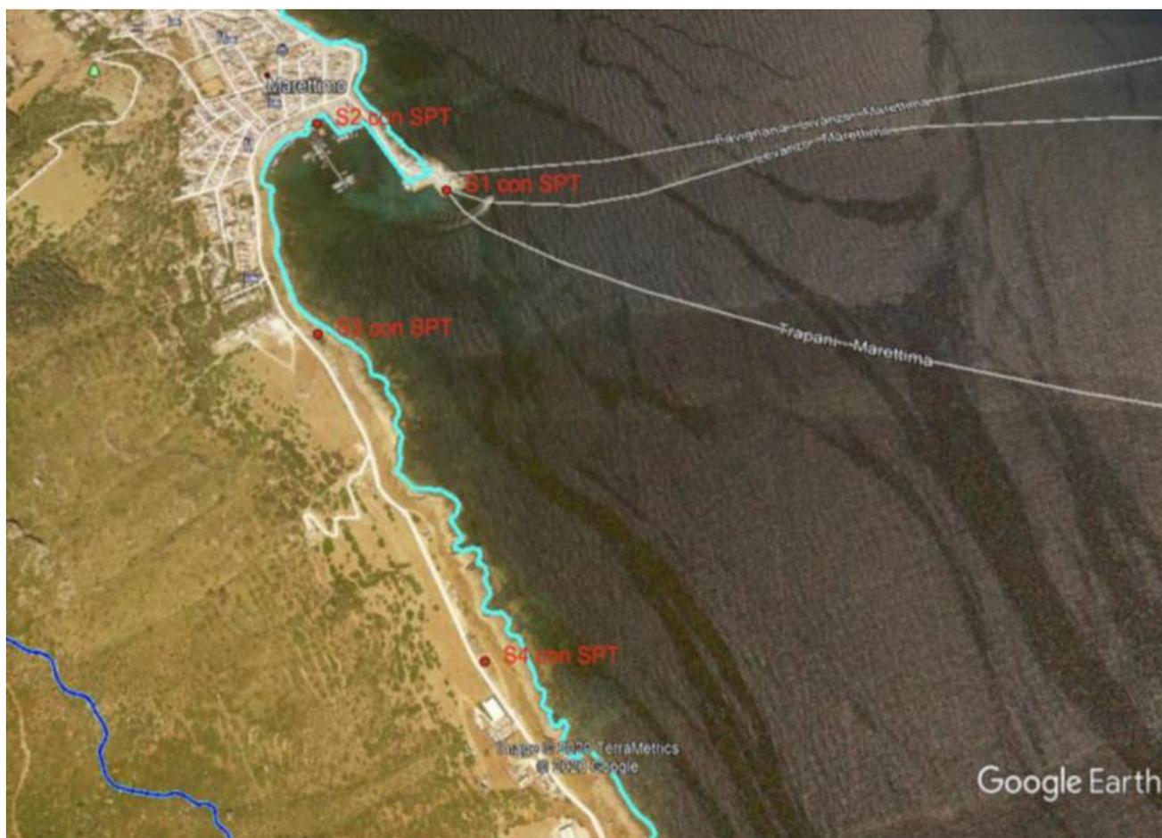
Figura 17 - Ubicazione sondaggi geognostici in foro con SPT
