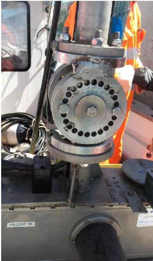
Figura 14 – Trasduttore MBES installato a sia sull'imbarcazione PIST 704 che sul gommone usato per le aree di basso fondale.
