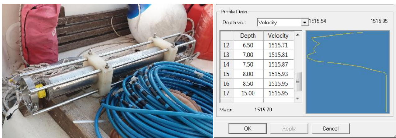
Figura 16 – Sonda CTD/SVP (Valeport MKIII) sull'imbarcazione durante le fasi di survey, a sinistra; Registrazione del profilo di velocità del suono in acqua ed inserimento dei dati nel software idrografico Qinsy (QPS), a destra.
