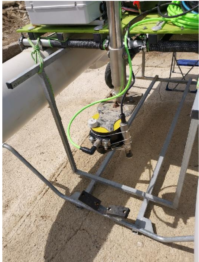
Figura 14 – Trasduttore MBES installato a sia sull'imbarcazione PIST 704 che sul gommone usato per le aree di basso fondale.
