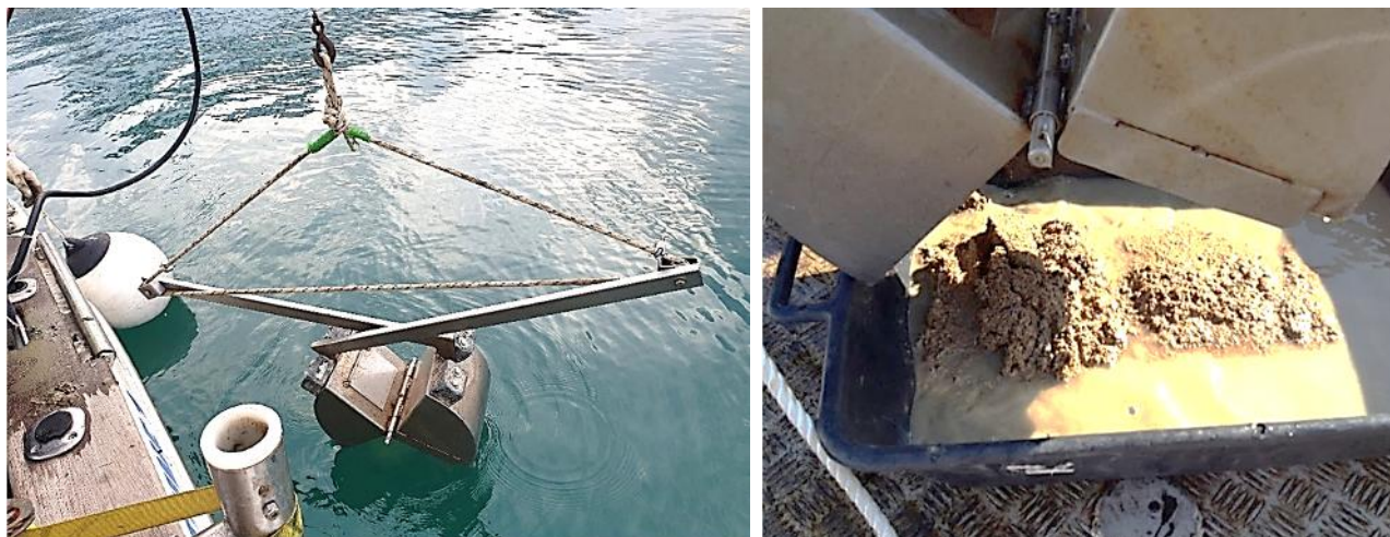
Figura 21 – Esempio di Benna Van Veen in fase di immersione (sinistra) e di apertura per recupero del campione prelevato (destra).
