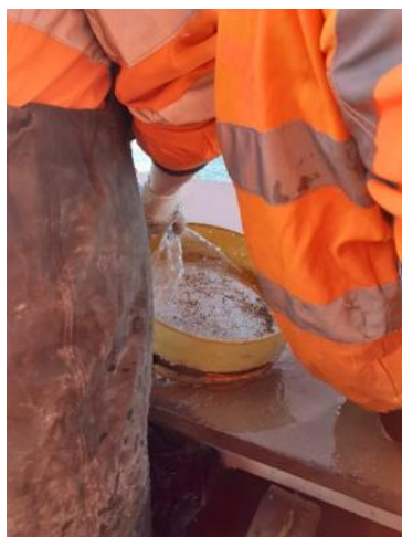
Figura 23 – Recupero del campione prelevato dopo l'apertura della Benna (sopra); risciacquo e setacciatura per la raccolta degli organismi bentonici (sotto).
