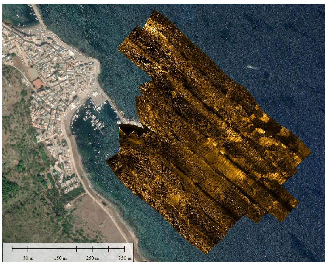
Figura 29 – Isola di Marettimo (TP): Ortofoto e Fotomosaico dell'area di indagine ottenuto montando insieme i sonogrammi registrati dal sistema side scan sonar.
