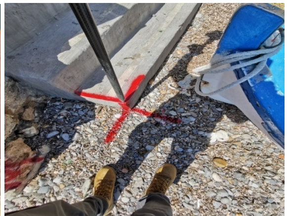
Figura 4.1 b – Alcuni Punti topografici d'appoggio fotogrammetrico utilizzati
