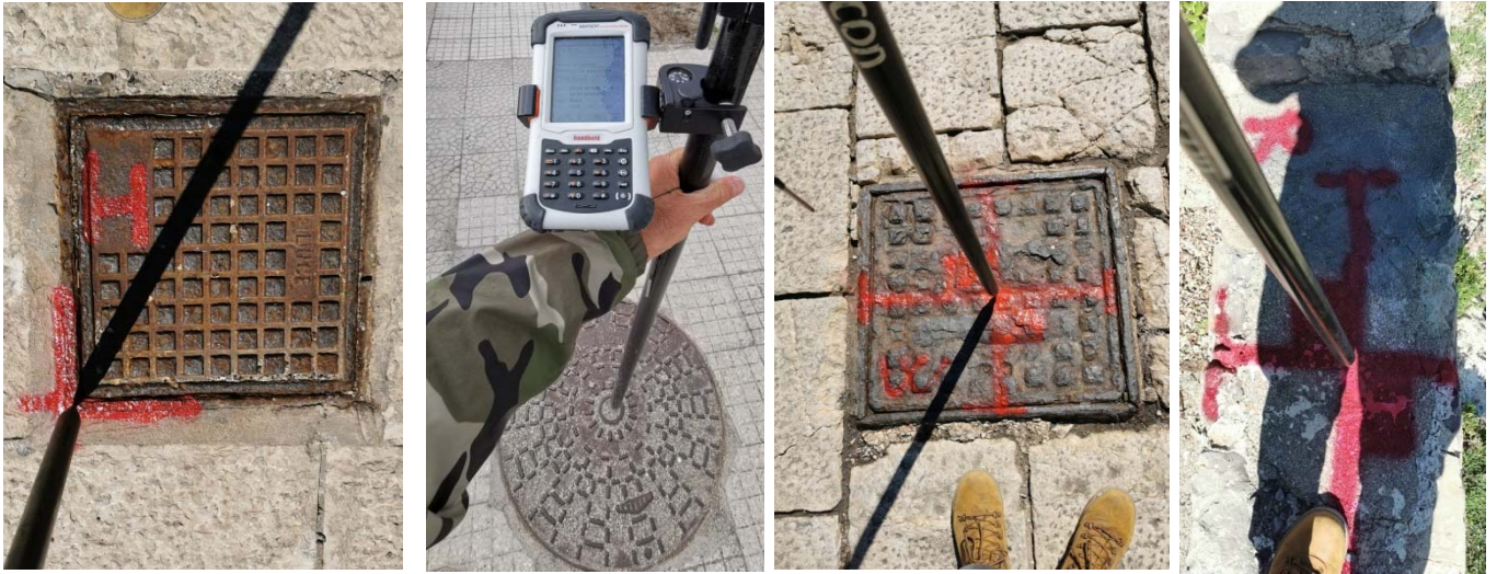
Figura 4.1 c – Alcuni Punti topografici d'appoggio fotogrammetrico (tombini) utilizzati
