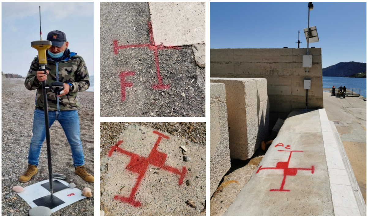
Figura 4.1 a – Alcuni Punti topografici d'appoggio fotogrammetrico (target) utilizzati
