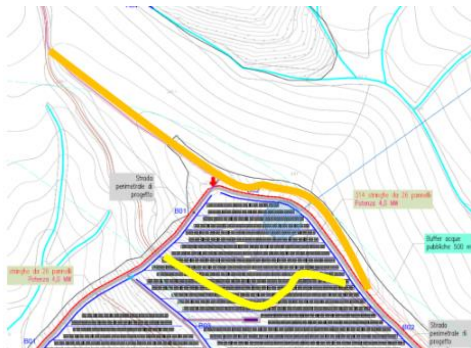
Figura 11. Intervento di sistemazione ed allargamento della strada adiacente esistente
