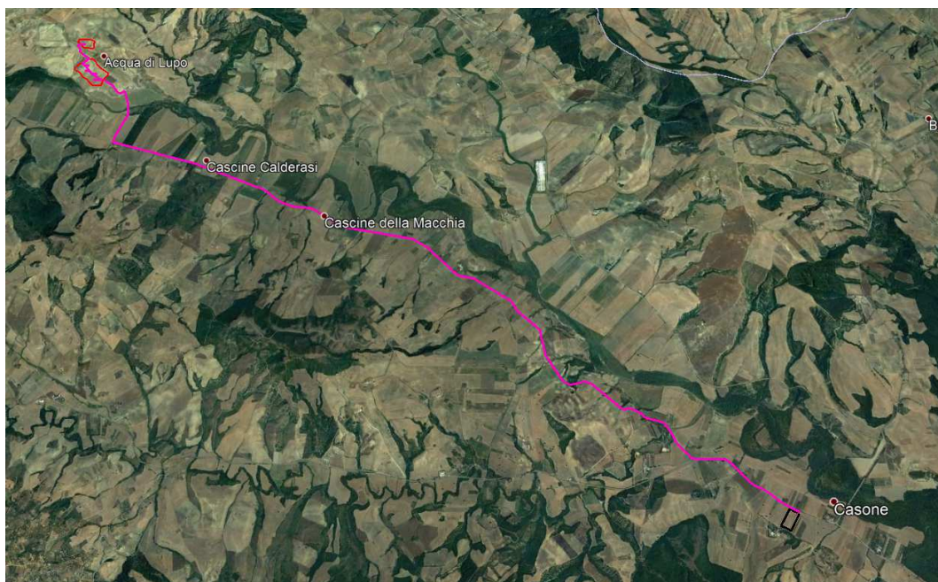
Figura 3 – Inquadratura geografica dell'impianto (in rosso) del cavidotto (in magenta) e della cabina (in nero)
