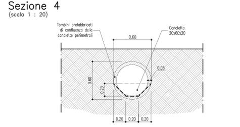
Particolari costruttivi del cavidotto interrato
