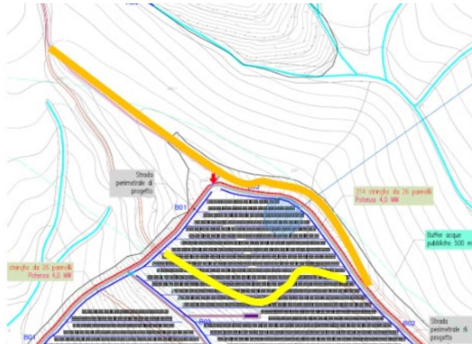
**Figura 8. Intervento di sistemazione ed allargamento della strada adiacente esistente**
