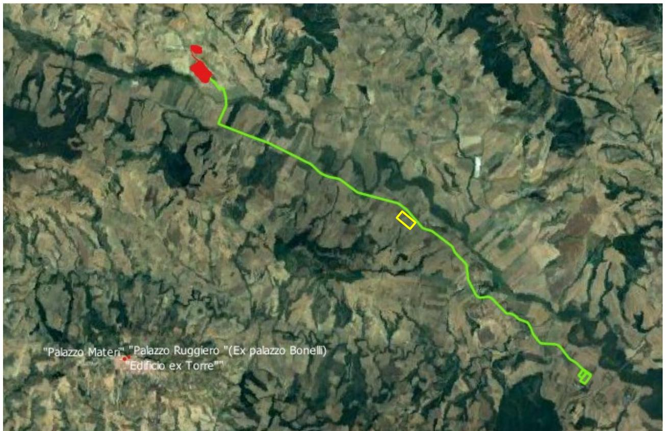
Figura 11: Estratto con evidenza dei beni monumentali, dell'area di impianto fotovoltaico (in rosso), del cavo di progetto e sottostazione (in verde) e dell'impianto di produzione e distribuzione dell'idrogeno (in giallo)
