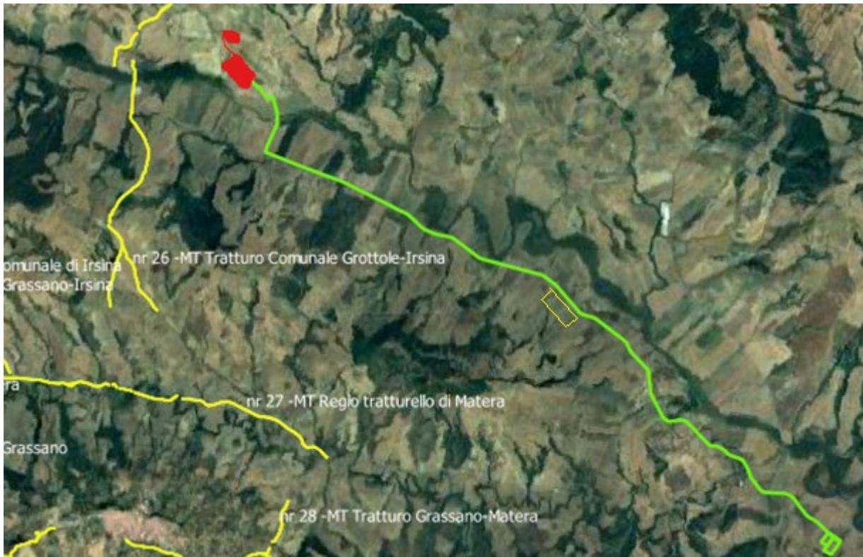
Figura 9: Estratto con evidenza dei tratturi (in giallo) e dell'area di impianto fotovoltaico (in rosso), del cavidotto di progetto e sottostazione (in verde) e dell'impianto di produzione e distribuzione dell'idrogeno (in giallo).
