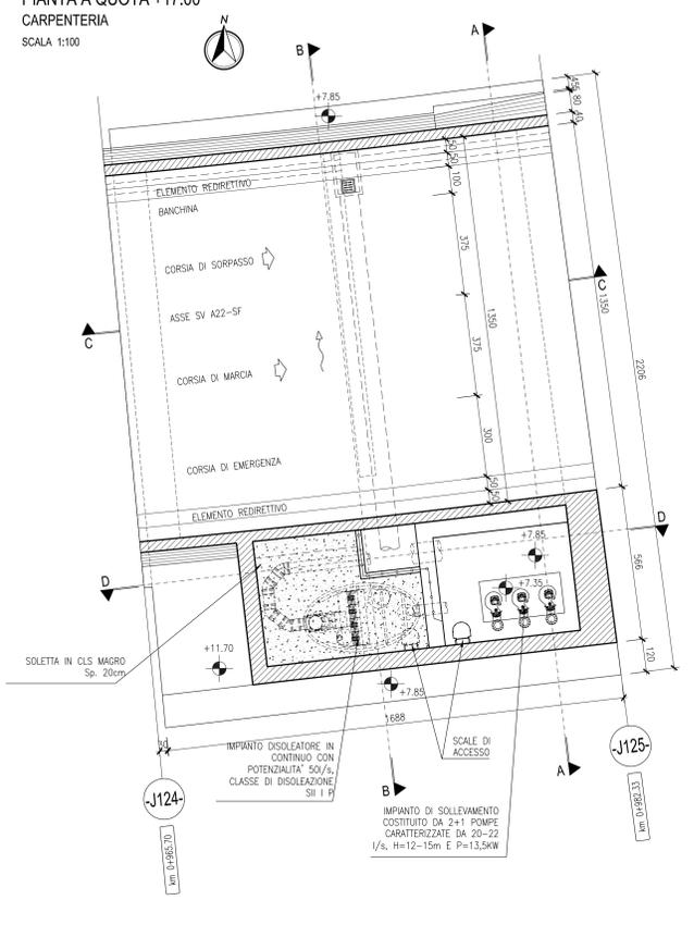
**PIANTA A LIVELLO DELLA VASCA DI ACCUMULO ACQUE CARPENTERIA**
