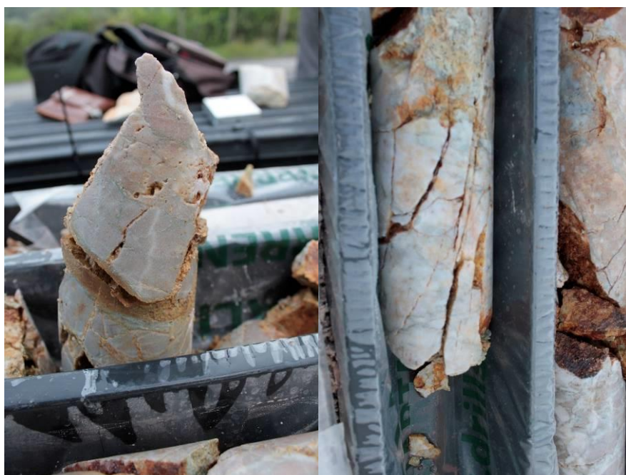
Figura 66. Spezzoni di carote del sondaggio SA7 con evidenze di strutture di dissoluzione nelle quarziti.
