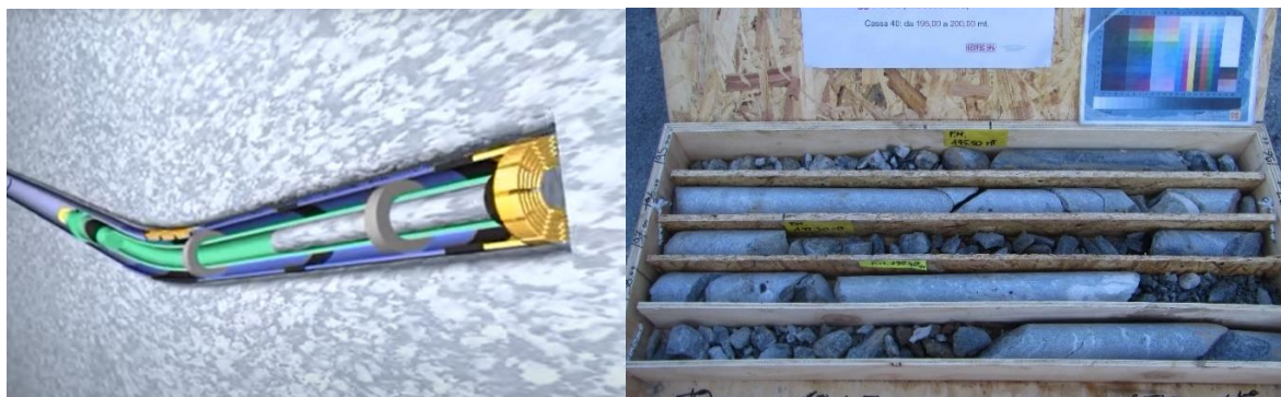
Figura 3.16 – Schema di carotaggio in orizzontale partendo dal foro deviato realizzato tramite HDD (immagine di sinistra), esempio di carote di sondaggio prelevate con wire-line di diametro HQ.
