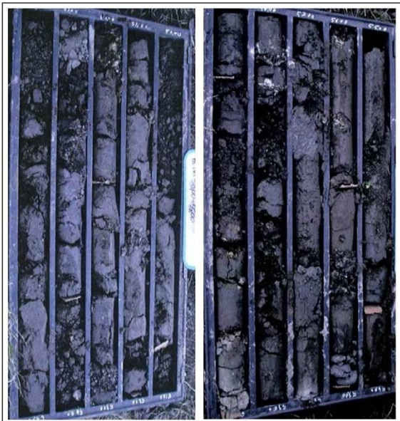
Figura 3.7 – Stratigrafie dei sondaggi prelevati a quota della galleria ferroviaria.
