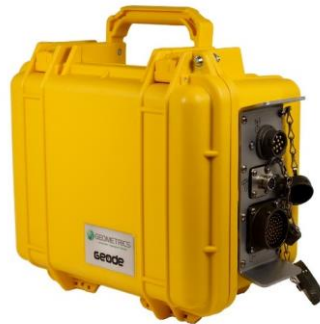
Figura 3.23 – Sismografo GEODE della Geometrics a 24 bit.
