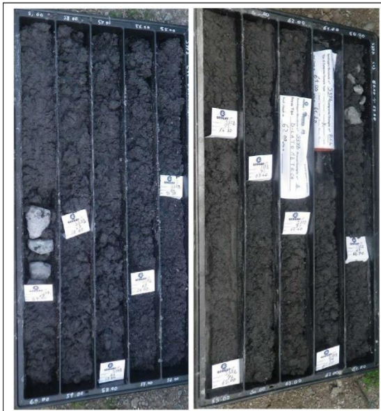
Figura 3.7 – Stratigrafie dei sondaggi prelevati a quota della galleria ferroviaria.
