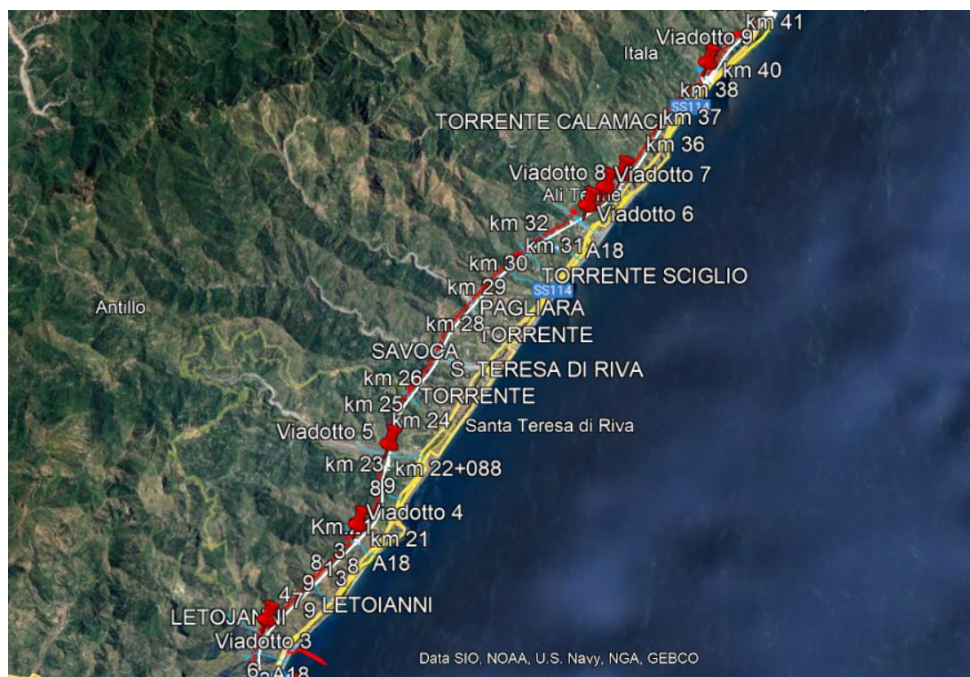
Figura 1 – Tracciato del Lotto 2 della linea ferroviaria Giampilieri – Fiumefreddo. I segnaposto rossi indicano la posizione dei sette viadotti elencati in Tabella 1.
