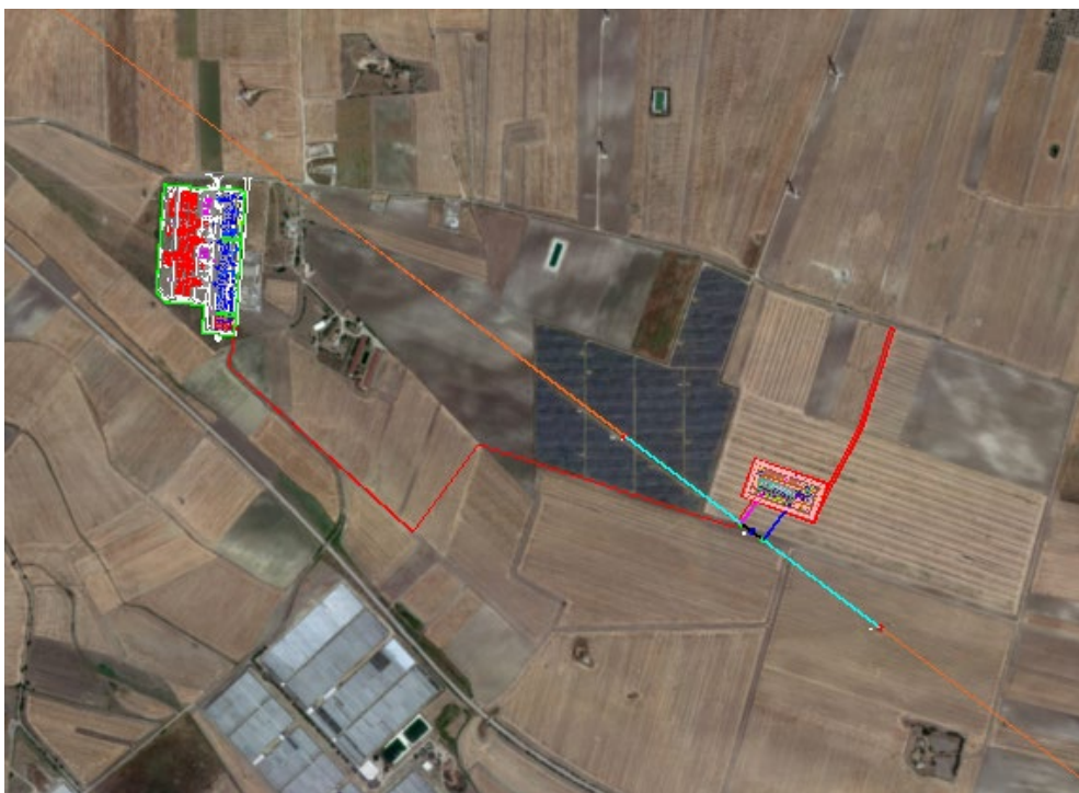
Figura 2 – individuazione dell’area destinata alla nuova SE RTN ed ai relativi raccordi aerei (in blu) e interrati (in rosso) di Deliceto (FG) su Ortofoto
