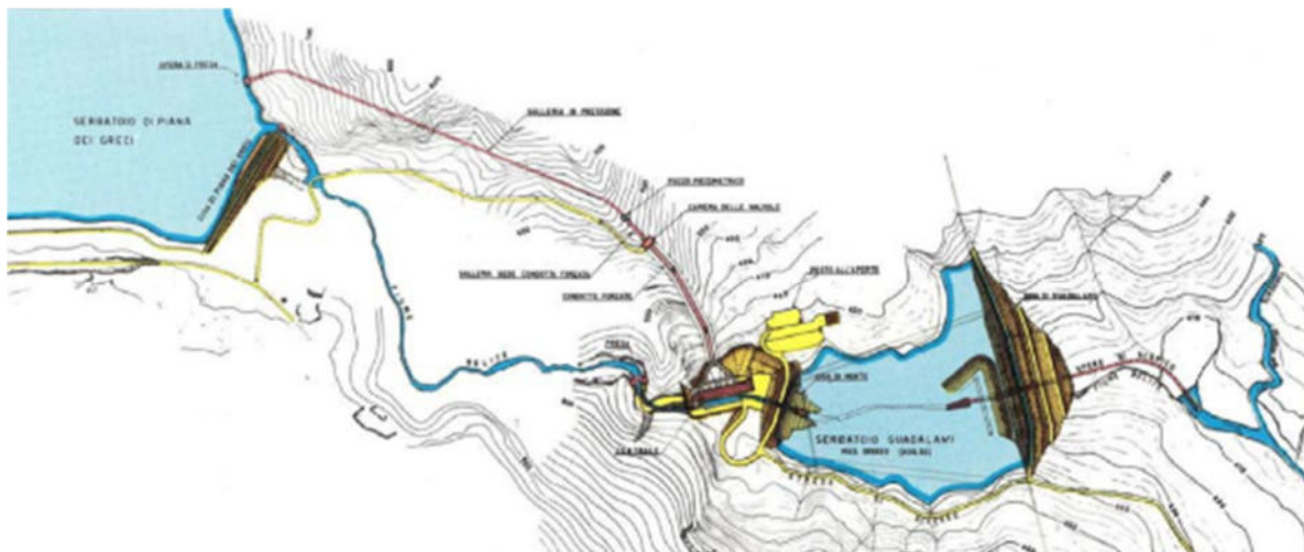
Figura 2: Planimetria generale dell'impianto di Guadalami (ENEL, 2013)
