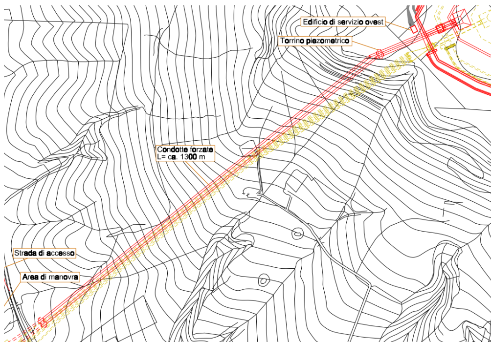
Figura 2. Modifiche intercorse nel tracciato delle condotte forzate.
