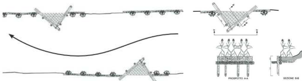
Figura 15. Esempi di deflettori di corrente.
