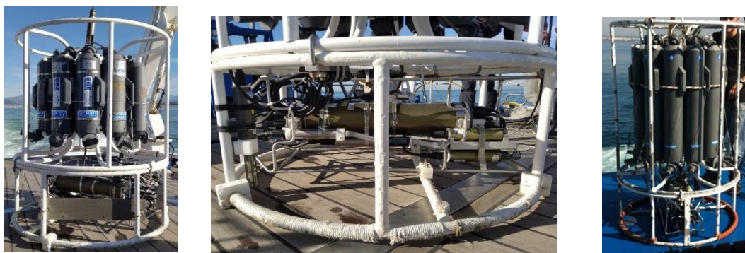
Figura 3.1.1.1. Sonda multi-parametrica (CTD) SBE 911 plus con multicampionatore di acqua Carousel SBE 32 con 12 bottiglie Niskin da 5 litri (figura a sinistra – a bordo dell'ASTREA) e da 10 litri (figura a destra – a bordo della Vettoria)
