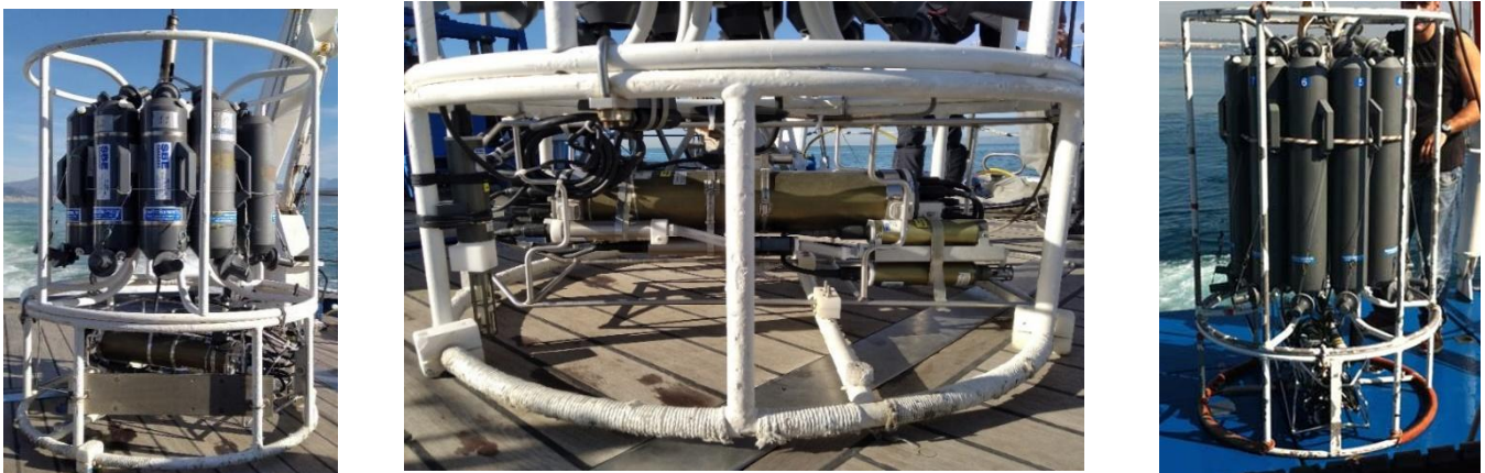
Figura 5.1.1.1. Sonda multi-parametrica (CTD) SBE 911 plus con multicampionatore di acqua Carousel SBE 32 con 12 bottiglie Niskin da 5 litri (figura a sinistra – a bordo dell'ASTREA) e da 10 litri (figura a destra – a bordo della Vettorina).
