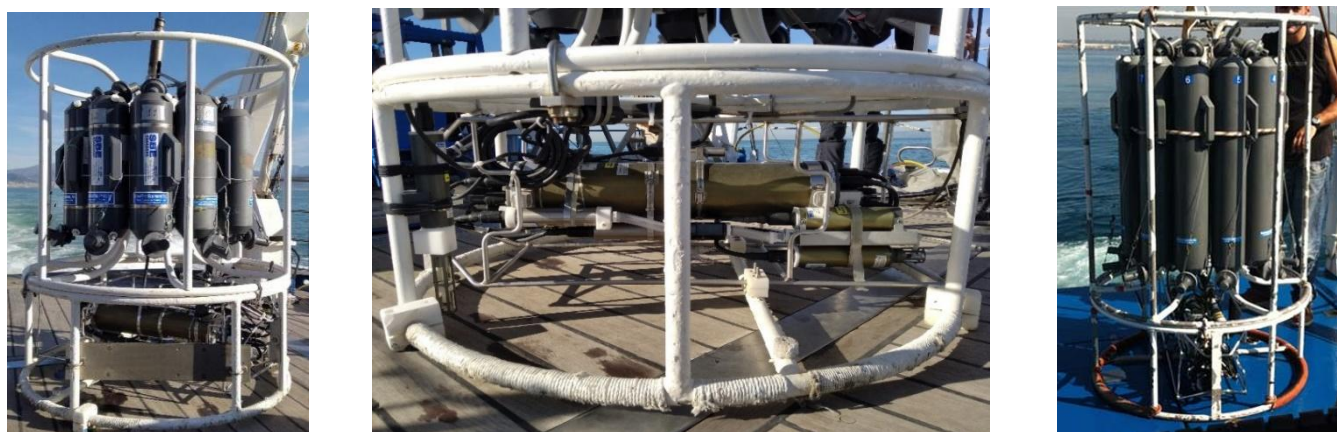
bottiglie Niskin da 5 litri (figura a sinistra – a bordo dell'ASTREA) e da 10 litri (figura a destra – a bordo della Vettoria).
