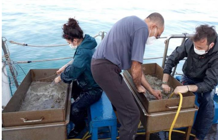
Figura 6.1.1. Benna Van Veen utilizzata e attività di setacciatura dei campioni prelevati.
