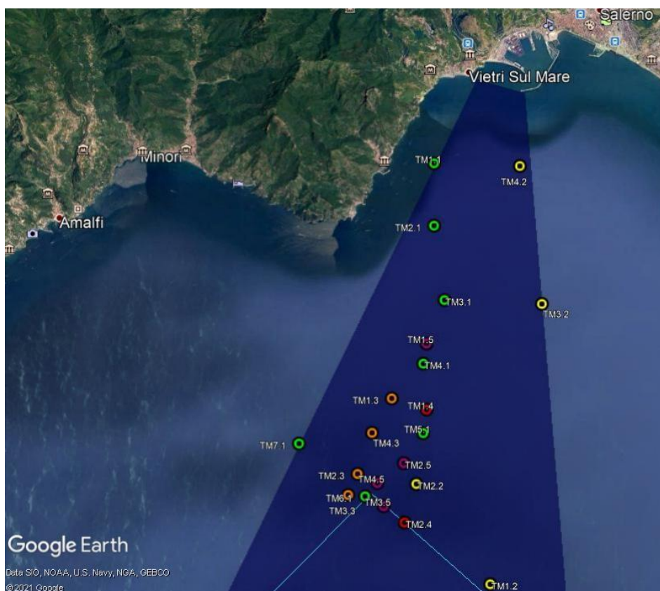
Figura 3.2.1. Stazioni di campionamento per il monitoraggio delle attività di trasporto materiali all'interno del ventaglio di possibili rotte della draga (in blu scuro). Le linee azzurre delimitano l'area di immersione.
