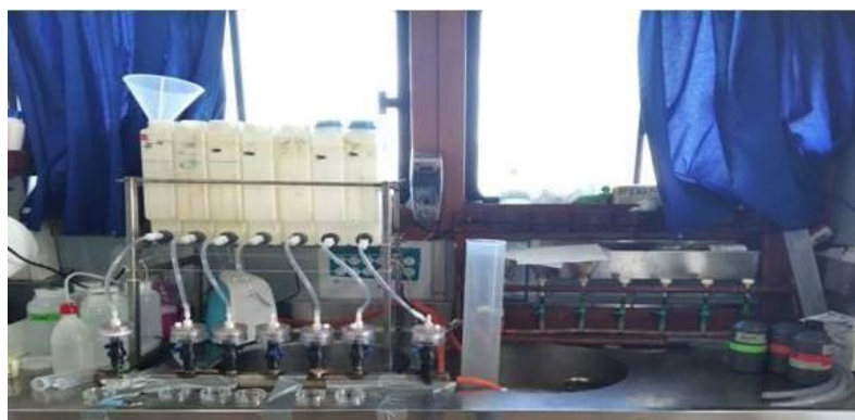
Figura 3.1.1.2 Apparato di filtrazione a bordo della nave Astrea.
